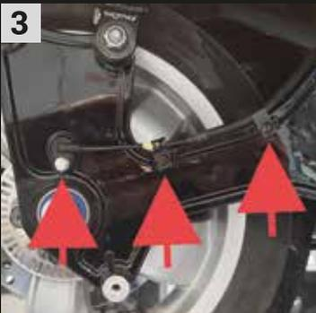
Schraube des ABS Sensors mit SW8 lösen. Schrauben der Kabelführung mit TX25 lösen. Alle Schrauben entfernen und den Sensor und das Kabel so am Fahrzeug verlegen das diese Bauteile beim abnehmen der Schwinge nicht beschädigt werden können.
