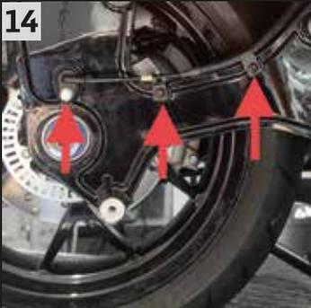
Wenn der Abstand vom ABS-Sensor zum Tonrad korrekt eingestellt ist, dann kann der ABS-Sensor und die Kabelführung mit SW8 und TX25 mit 4 -5Nm\*\* befestigt werden.
