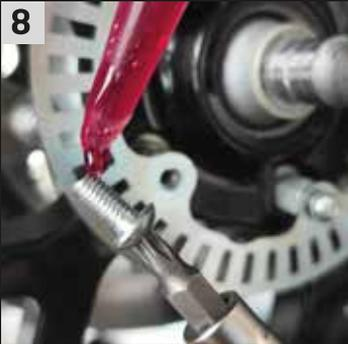
Schrauben des Tonrades mit flüssiger Schraubensicherung mittlerer Festigkeit einsetzen und mit IS 4 mit 5 Nm \*\* anziehen.
