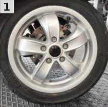
Das Fahrzeug unterhalb des Rahmens an geeigneter und tragfähiger Stelle unterbauen, so dass das Vorderrad keinen Bodenkontakt hat.
