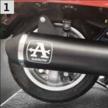
Auspuffschele am Krümmer mit SW17 lösen. Drei Schrauben am Auspuff mit TX40 lösen und entfernen. Anschließend den Auspuff abnehmen.
