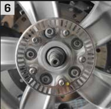
Schrauben des Tonrades mit IS 4 lösen und entfernen. Radschrauben mit IS 6 lösen und entfernen. Auf den Verbleib der Scheiben und Sicherungselemente achten. Rad abnehmen.
