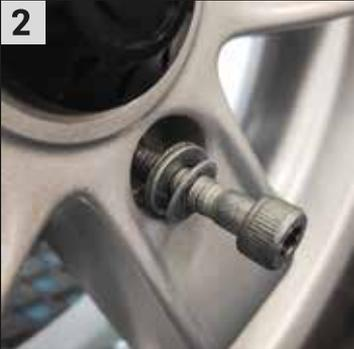
Radschrauben mit IS 6 lösen. Beim Entfernen der Radschrauben auf den Verbleib der Scheiben und Sicherungen achten.
